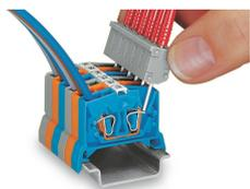
Contact direct, sur le ressort de la connexion CAGE CLAMP®, le courant nominal est limité à 0,5 A et la tension de test maximale à 48 V ; les broches de test ne sont pas protégées contre les contacts.
