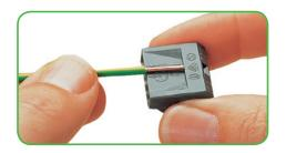
La longueur de dénudage est de 10 à 13 mm. La mesure peut être faite grâce à la toise intégrée à la borne.
