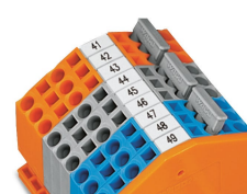
Bornes de passage pour 4 conducteurs, type incliné formation de groupes avec des peignes de pontage à 3 pôles
