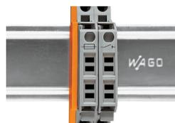
Des bornes à fusibles ou bornes sectionnables d'une largeur de 8 mm peuvent être assemblées directement les unes aux autres. En fin de barrette ou s'il **n'y a pas** de borne à fusible ni de borne sectionnable adjacente, il faut utiliser une plaque intermédiaire ou d'extrémité.
