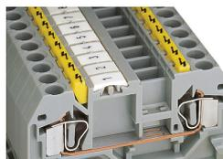
Obturateurs de protection avec signalisation de danger montés dans l'ouverture de manipulation
