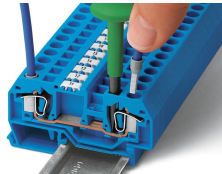
Connexion CAGE CLAMP® Raccordement du conducteur. Pour les conducteurs munis d'embouts d'extrémité, il faut choisir une borne acceptant une section nominale de taille supérieure.
