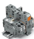
Les ponts réducteurs sont conçus pour la connexion entre les bornes de passage de grandes sections et de petites sections, sans perte de points de connexion. Ils ont par ex. un intérêt lorsque pour de grandes longueurs de conducteurs la chute de tension doit être maintenue faible, mais que « sur place » la section nominale suffit.
