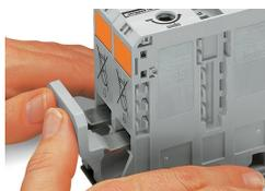
Pontage de bornes adjacentes avec un contact de pontage horizontal au-dessus du point de connexion pour conducteur avant raccordement ; la section nominale est maintenue.
