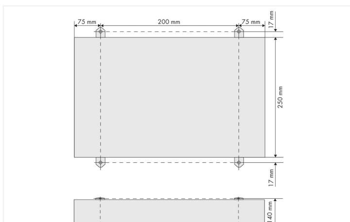
Le distributeur météo **flexROOM®-Weather** sert à l'acquisition et la distribution de données météo dans le cadre d'un réseau d'automatisation de bâtiment présent dans des distributeurs de bureau **flexROOM®-Office**.
