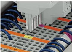
Enfichage correct par dispositif détrompeur
