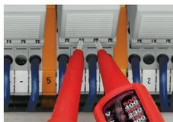
Tester le fonctionnement par simple contact protégé
