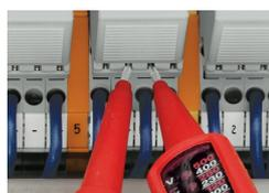
Tester le fonctionnement par simple contact protégé
