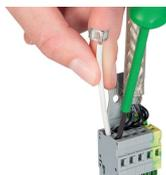
Placer le transfert de blindage dans le connecteur femelle à l'aide de l'outil de manipulation.
