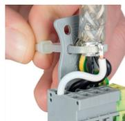
À l'aide des serre-câbles, fixer la tresse de blindage et le transfert de blindage à la plaque de décharge de traction.
