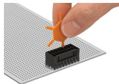
Codage d'un connecteur femelle en faisant glisser un détrompage.
