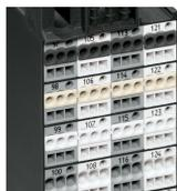
Introduire le réducteur isolant dans les ouvertures d'introduction des matrices de répartition.
