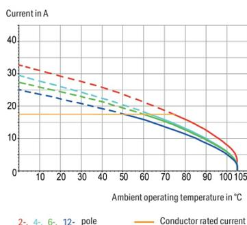
Borne pour circuits imprimés série 739 avec introduction du conducteur vers la platine de 90 °
