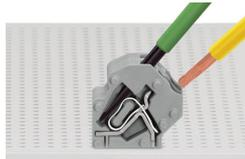
Connexion du conducteur avec outil de manipulation (lame 3,5 mm)
