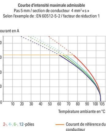
Borne pour circuits imprimés série 745 pas de 5 mm
