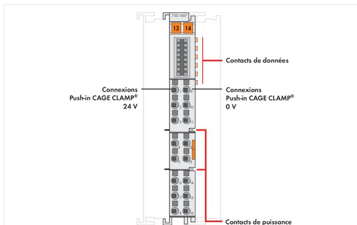
Cette borne de distribution de polarités, en combinaison avec la borne d'entrée/sortie à 8 canaux réf. 750-1506 (également pour bornes de bus à 8 canaux avec raccordement à 1 fil), met à disposition les potentiels 24V et 0V pour les entrées/sorties.
