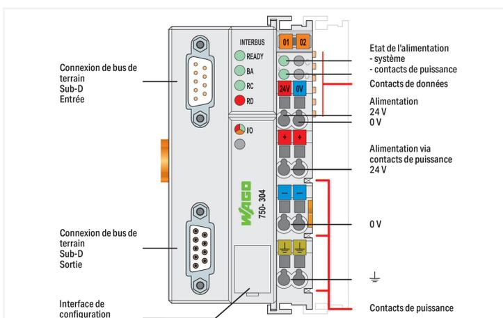
Ce coupleur permet de connecter les bornes WAGO-I/O-SYSTEM au réseau INTERBUS en tant que station esclave sur le bus interstation.
