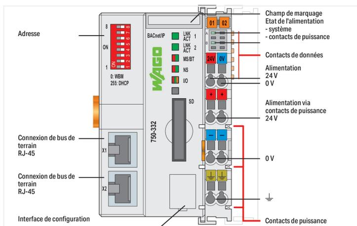
Le coupleur de bus de terrain BACnet/IP (750-332) permet de connecter le système modulaire WAGO I/O System au protocole BACnet. Le 750-332 remplit les exigences du profil de dispositif BACnet B-BC selon la norme DIN EN ISO 16484-5.
