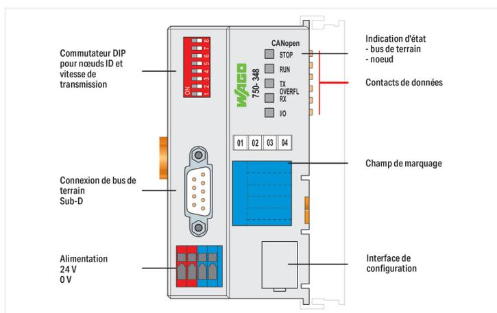
Les coupleurs de bus de terrain ECO disposent d'une table image concentrée. Ils sont particulièrement adaptés aux applications avec des signaux digitaux (TOR) et un nombre réduit de signaux analogiques.
