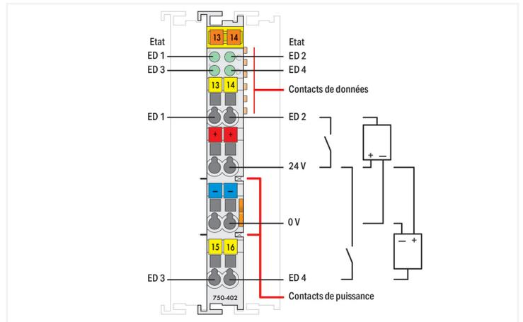
La borne d'entrées digitales (T.O.R) permet de raccorder des capteurs et des contacts secs.
