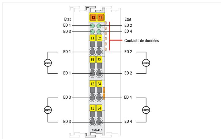
La borne d'entrées digitales (T.O.R) permet de raccorder des capteurs et des contacts secs.
