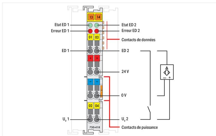
La borne d'entrées digitales (T.O.R.) permet de raccorder des capteurs et des contacts secs au réseau. Elle alimente le capteur avec une tension protégée contre les courts-circuits. La borne de bus transmet les signaux d'acquittement et les informations correspondantes au système de contrôle via la tête de station.
