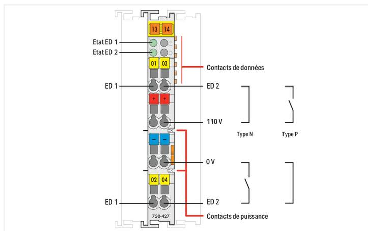
La borne d'entrées digitales (T.O.R) permet de raccorder des capteurs et des contacts secs. La borne dispose de 2 canaux. Chaque canal peut être configuré individuellement en type P ou en type N. La configuration dépend du câblage externe. La séparation galvanique bus de terrain/bornes est assurée par des optocoupleurs.
