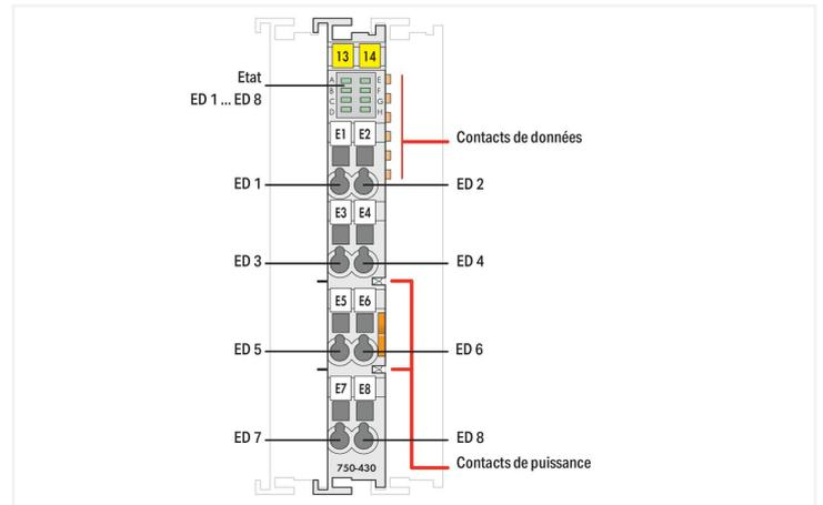
Cette borne d'entrées digitales (T.O.R.) de seulement 12 mm de largeur dispose de 8 canaux. Elle permet de raccorder des capteurs et des contacts secs.
