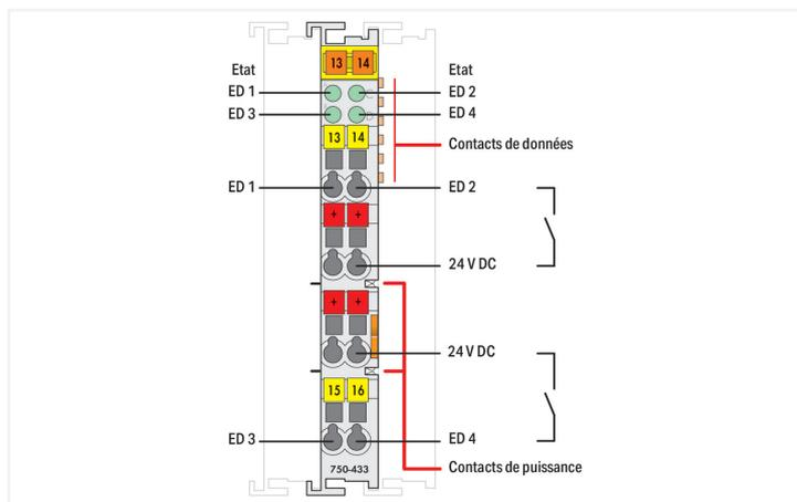
La borne d'entrées digitales (T.O.R) permet de raccorder des capteurs et des contacts secs. Cette borne dispose de quatre canaux d'entrée et permet de raccorder directement quatre capteurs de 2 fils, car elle dispose de quatre points de raccordement 24 V. Pour éviter toute perturbation, chaque entrée est munie d'un filtre avec une constante de temps. La séparation galvanique bus de terrain/bornes est assurée par des optocoupleurs.
