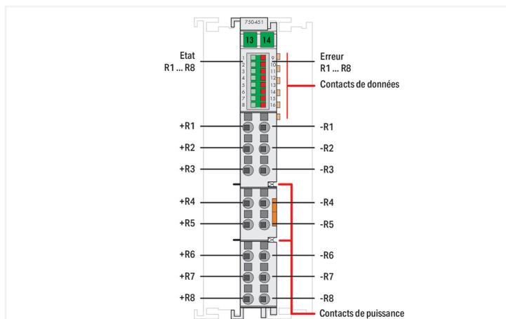
La borne d'entrées analogiques permet une connexion directe des sondes de température Pt ou Ni ainsi que des capteurs résistifs.
