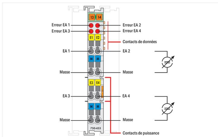
La borne d'entrées analogiques traite des signaux sur une plage de courant standardisée de 0 ... 20 mA.
