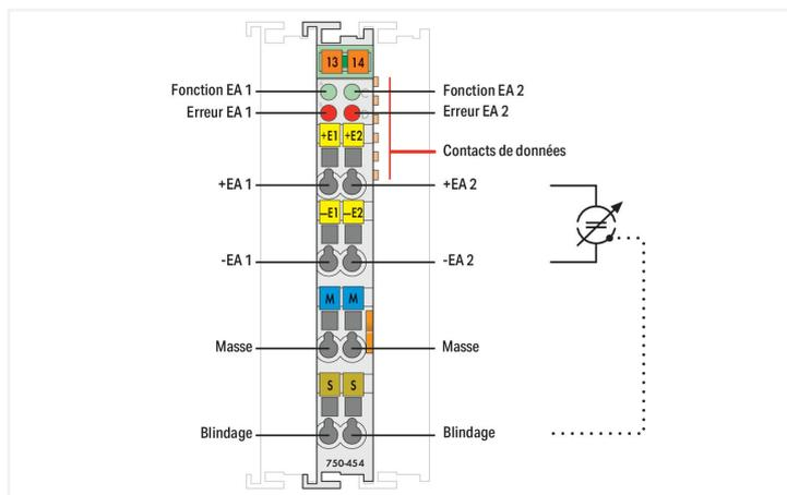
La borne d'entrées analogiques traite des signaux sur une plage de courant standardisée de 4 ... 20 mA.
