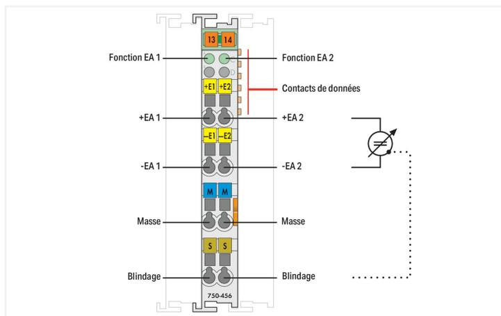
La borne d'entrées analogiques traite des signaux sur une plage de tension standardisée de  $\pm 10$  V.
