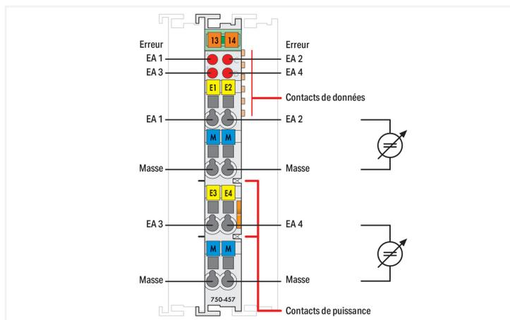
La borne d'entrées analogiques traite des signaux sur une plage standardisée  $\pm 10$  V.
