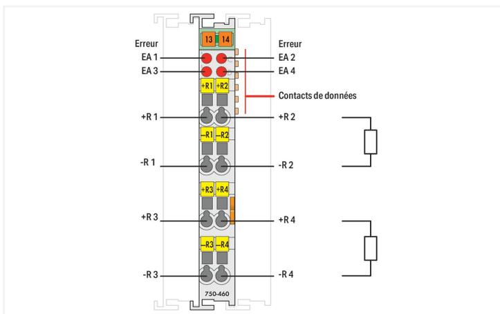
La borne d'entrées analogiques permet une connexion directe de sondes de température Pt.
