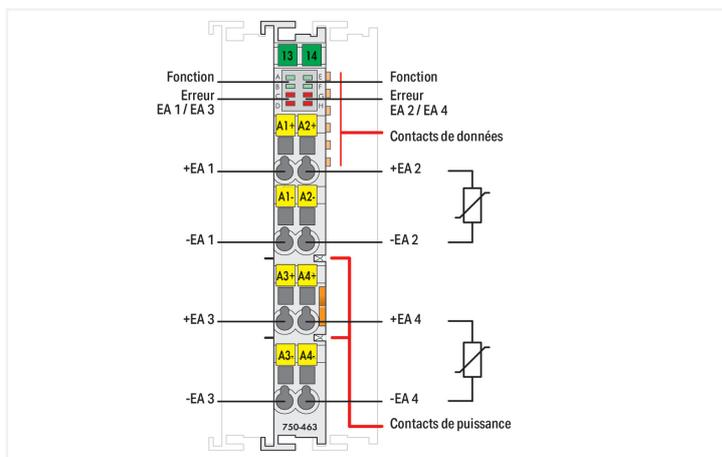
La borne d'entrées analogiques permet une connexion directe des sondes de température sélectionnées Pt ou Ni. Elle peut être utilisée exclusivement comme borne à 4 canaux (technique de raccordement à 2 fils). La plage de température se situe dans les limites -30 °C à +150 °C.
