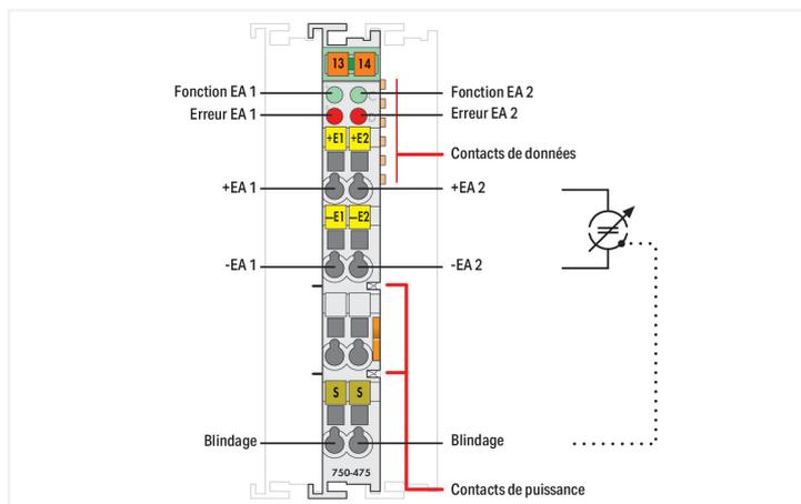
La borne d'entrées analogiques traite des signaux sur une plage de courant AC et DC de 0 ... 1 A eff.
