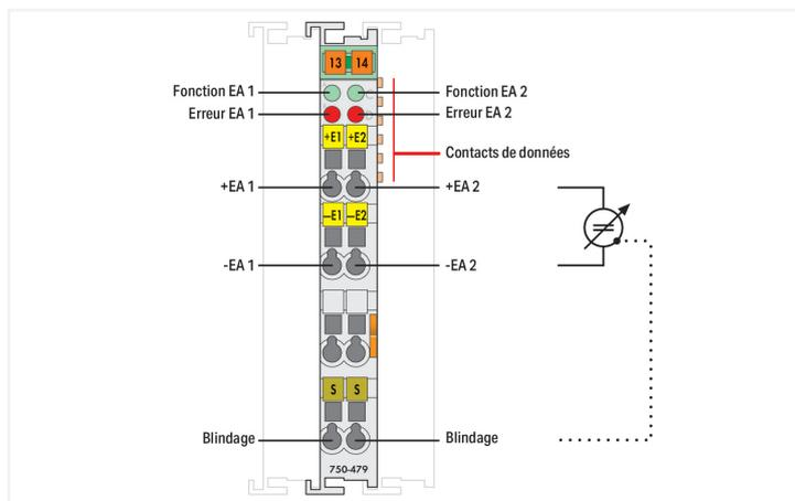
La borne d'entrées analogiques traite des signaux différentiels sur une plage de tension de ±10 V DC.
