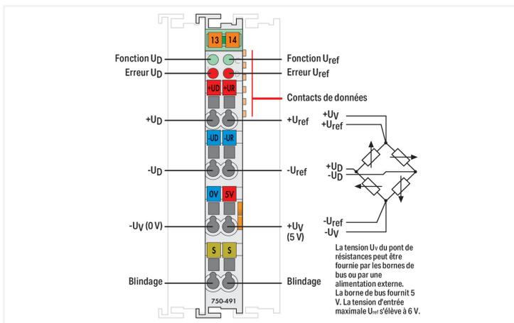
La borne d'entrée analogique permet la connexion directe d'un pont de résistances (jauge de contrainte). La tension du pont  $U_D$  et la tension d'alimentation  $U_{ref}$  du pont seront numérisées avec une résolution de 16 bits.
