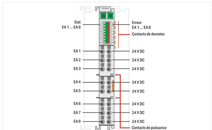
La borne d'entrées analogiques traite des signaux sur une plage de courant standardisée de 0 ... 20 mA, 4 ... 20 mA ainsi que 3,6 ... 21 mA (Namur NE43).
