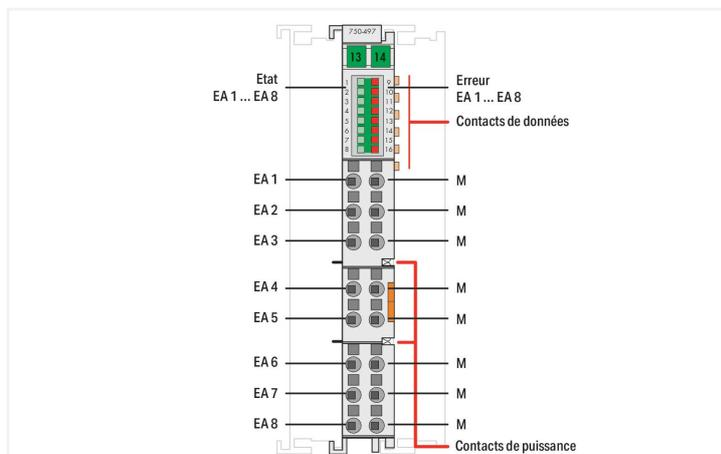
La borne d'entrées analogiques traite des signaux sur une plage standardisée de 0 ... 10 V DC et ± 10 V DC.
