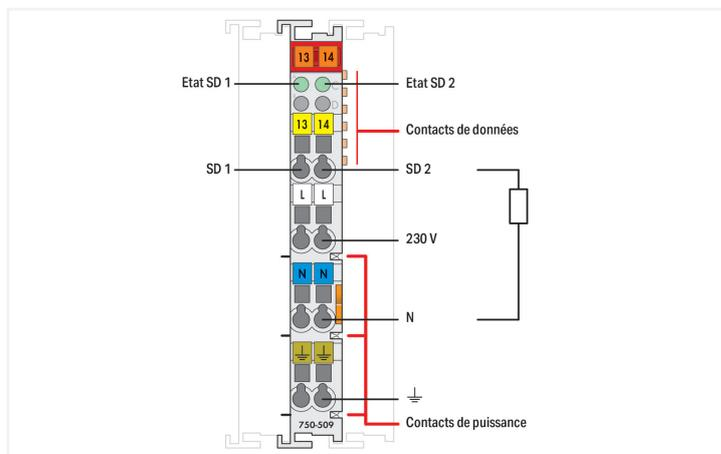
L'automate programmable transmet ses signaux de commande aux actionneurs connectés par l'intermédiaire des bornes de sorties digitales. La commande de la sortie à transistor s'effectue dans un environnement galvaniquement protégé à partir de la tension interne du système. Les contacts de puissance sont soumis à la tension d'alimentation.
