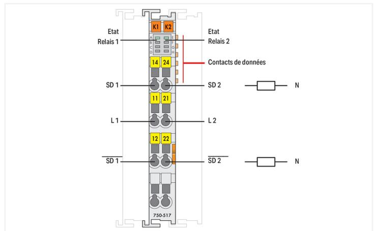
L'automate programmable transmet ses signaux de commande aux actionneurs connectés par l'intermédiaire des bornes de sorties digitales.
