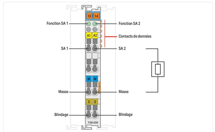
La borne de sorties analogiques génère des signaux analogiques sur une plage de tension standardisée de 0 ... 10 V. Le signal de sortie est séparé galvaniquement et le transfert au coupleur se fait sur une unité d'adressage de 12 bits. Les sorties sont protégées contre les courts-circuits. Pour l'alimentation, la tension interne est utilisée pour le module d'alimentation. Les canaux des bornes de sorties possèdent un potentiel de référence commun.
