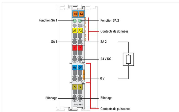
La borne de sorties analogiques génère des signaux analogiques sur une plage standardisée de 4 ... 20 mA.
