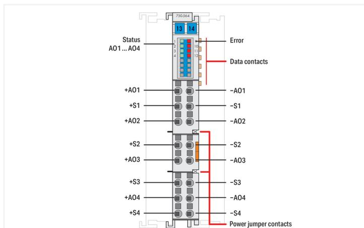
La borne de sorties analogiques peut émettre une variété de signaux normalisés de tension et de courant.
