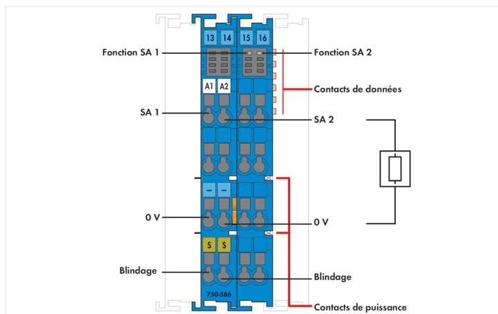
La borne de sorties analogiques génère des signaux intrinsèques 4 ... 20 mA dans les milieux à risque d'explosion des zone 0+1.
