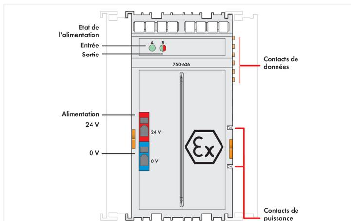
La borne d'alimentation sert à alimenter toutes les bornes Ex i à sécurité intrinsèque de la série 750. Elle contrôle l'alimentation en courant du segment Ex i placé en aval et sépare la partie intrinsèque et non-intrinsèque du système WAGO-I/O-SYSTEM 750. Les alimentations d'entrée et de sortie sont isolées galvaniquement.
