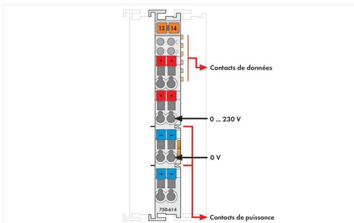
Cette borne met à disposition plusieurs points de connexion pour la tension d'alimentation.
