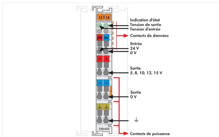
La borne 750-623 s'alimente en 24 V DC et elle fournit les tensions de sortie DC 5 V, 8 V, 10 V, 12 V, 15 V.
